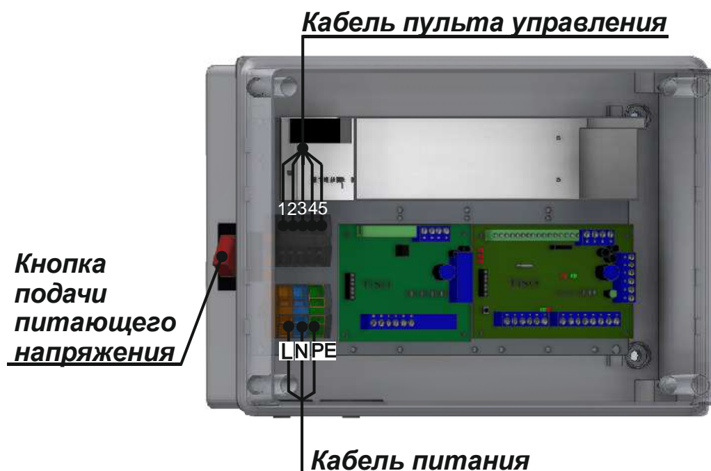
Рис.12– Блок электронного управления – подключение турникета
