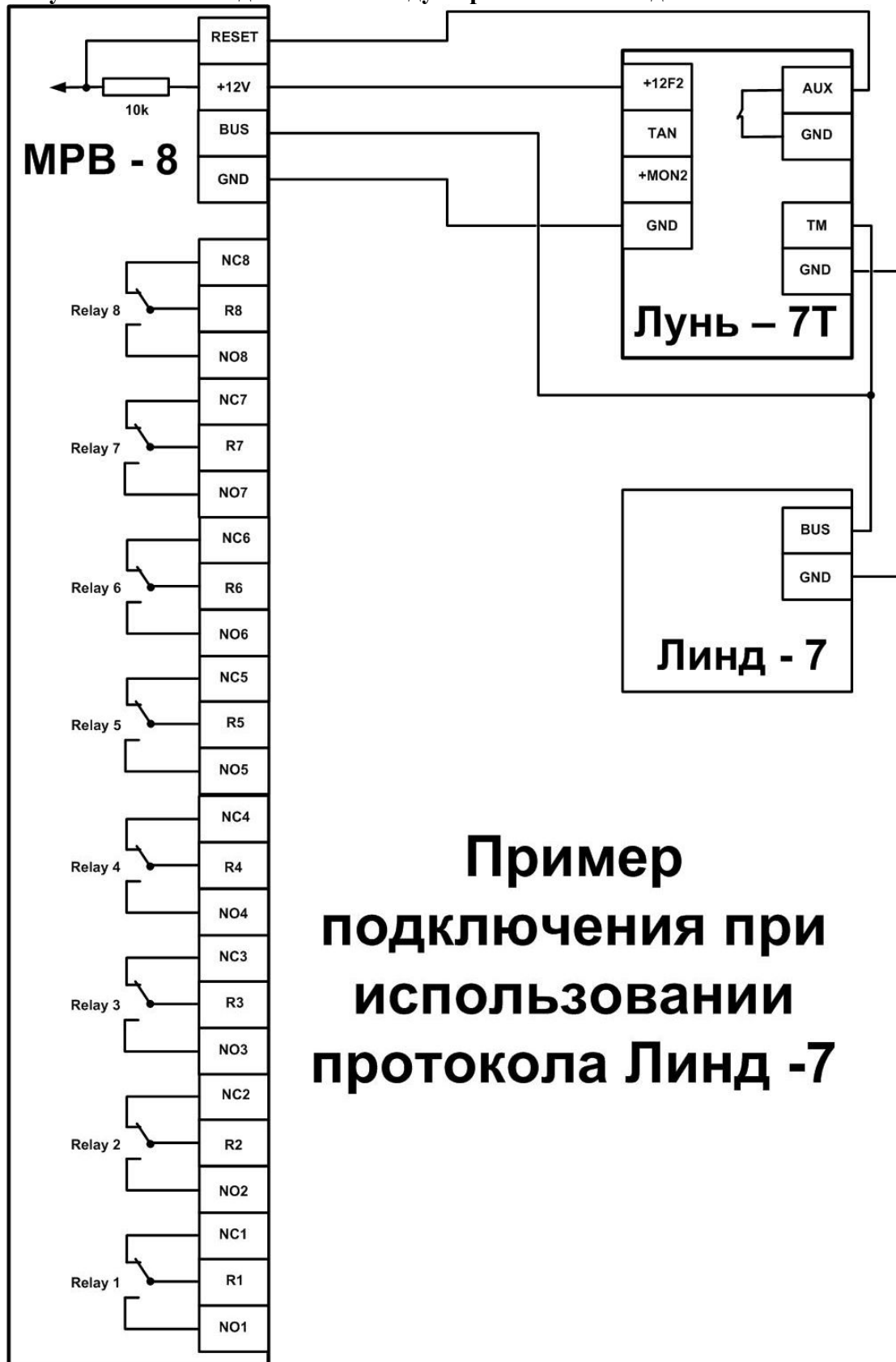
Рисунок 9 Схема подключения модуля релейных выходов МРВ-8
